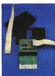
Il controller che collega il modulo al computer. Sotto lo che espone tutti i segnali del bus del 64.
